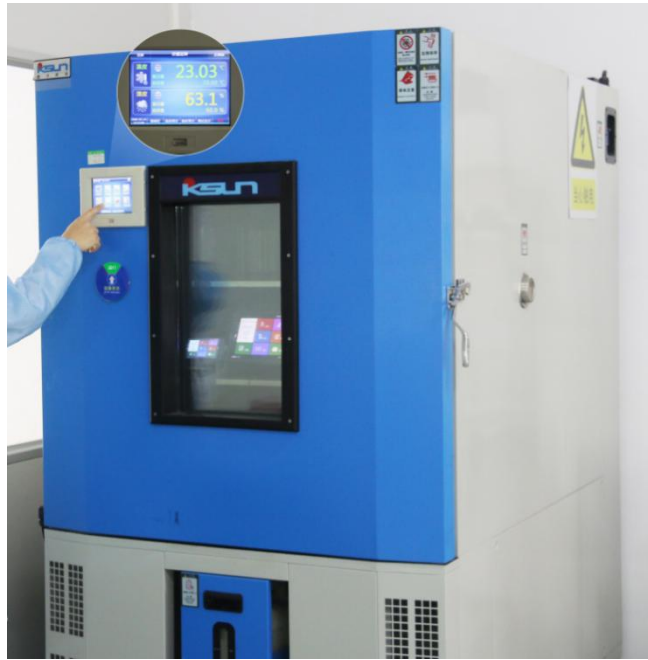
图 5-3 高低温老化测试图
